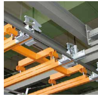
Verschiebebrücken für den Quertransport zur Versorgung einzelner Stichbahnen im Lackier- und Trocknungsbereich
