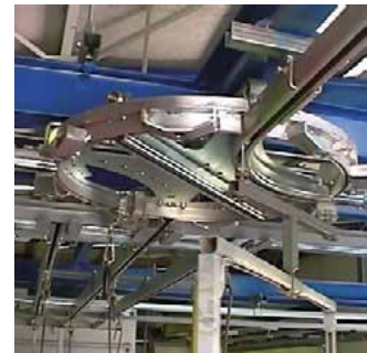
Drehweichen zur Regelung des Materialflusses an Kreuzungspunkten, manuell oder pneumatisch
