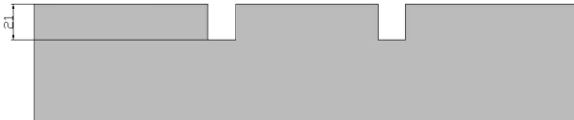
Abbildung 3.7: Frästiefe ohne Bodenbeschichtung
