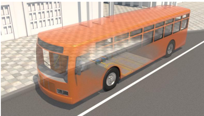
BU: Hohe Ladeleistungen beim kurzen Halt von Elektrobussen erlauben ganztägigen Betrieb
