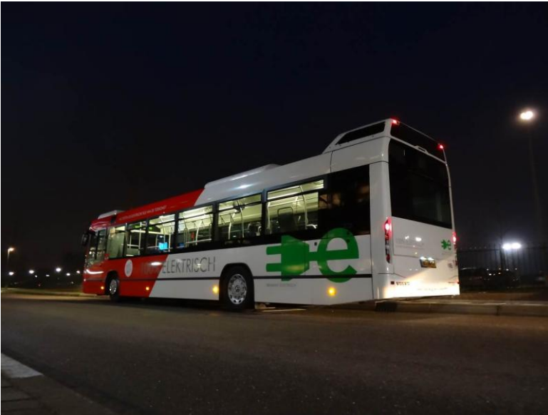
BU: Ein 12-Meter-Elektrobus hat mit IPT dreimal längere Betriebszeiten (Conductix-Wampfler)
