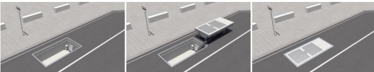
BU: Nach Tiefbauarbeiten wird der Betonschacht an der Haltestelle eingebaut, das Lademodul wird mit dem Stromnetz verbunden und nach der Montage ist nur die Ladeplatte sichtbar, die Straße barrierefrei nutzbar
